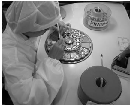
Eine Mitarbeiterin der Firma Ronda (Niederlassung Thailand) bei der Fertigung elektronischer Uhrwerke.
